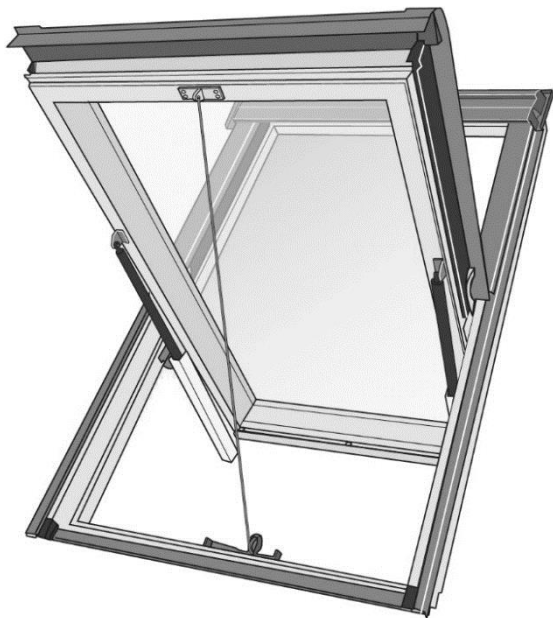
Schéma d'un exutoire GGL SEVM sans déflecteurs
